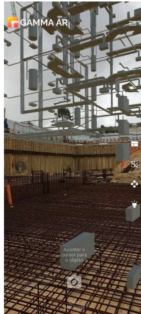
Fig. 15. Realidade Aumentada - Modelo de Instalações Mecânicas.
